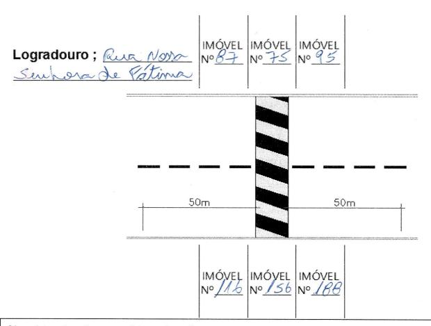
Obs.: A localização pretendida será analisada por um técnico que poderá optar por um local mais adequado. Sempre que possível, o redutor deve ficar embaixo do poste de iluminação e distante de: boca de lobo, bueiro, encanamento de água, hidrante e guia rebaixada.
