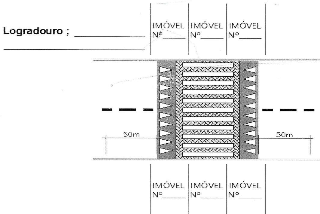
Obs.: A localização pretendida será analisada por um técnico que poderá optar por um local mais adequado. Sempre que possível, o redutor deve ficar embaixo do poste de iluminação e distante de: boca de lobo, bueiro, encanamento de água, hidrante e guia rebaixada.
