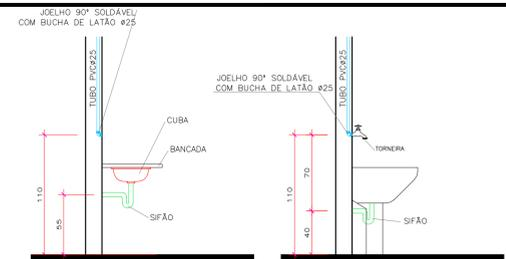
VISTA LATERAL DA LIGAÇÃO DE ÁGUA/ESGOTO Sem Escala
