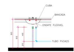
VISTA FRONTAL DA LIGAÇÃO DE ÁGUA/ESGOTO Sem Escala
