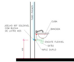
VISTA LATERAL DA LIGAÇÃO DE ÁGUA/ESGOTO Sem Escala
