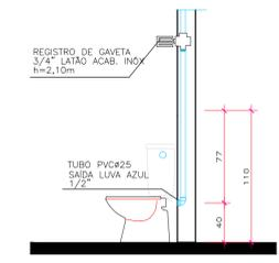
Detalhe Válvula de Descarga Sem Escala
