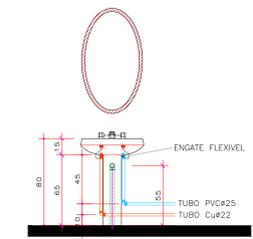
VISTA FRONTAL DA LIGAÇÃO DE ÁGUA/ESGOTO Sem Escala
