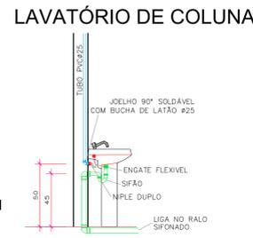
VISTA LATERAL DA LIGAÇÃO DE ÁGUA/ESGOTO Sem Escala
